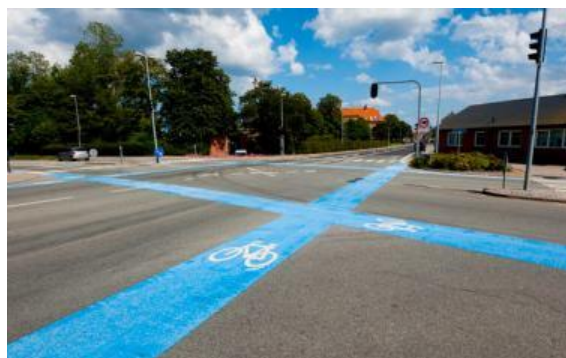
תמונה ב-9: שבילי אופניים ואזורי קונפליקט כחולים בדנמרק (מקור: http://john-s-allen.com/blog/?p=2293 )
