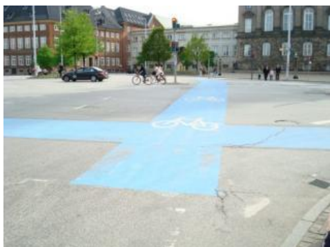
תמונה ב-9: שבילי אופניים ואזורי קונפליקט כחולים בדנמרק (מקור: http://john-s-allen.com/blog/?p=2293 )
